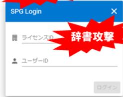
IDの入力がある回数間違えると、次入力できるまで停止します。さらに間違えると停止時間が伸び、停止時間を可変長にすることで、攻撃するコンピュータを混乱させます。SPG-Remoteは、優れたサイバー攻撃を仕掛けられた場合、破られるまでに、平均8万年かかる設計です。
